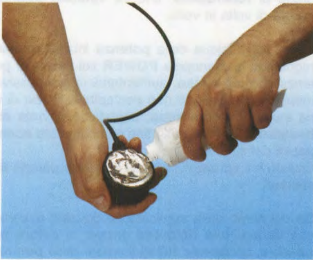
Fig.22 Prima dell'uso il diffusore deve sempre essere cosperso uniformemente con uno strato di gel conduttore di circa 1 mm di spessore. Non dimenticate di effettuare questa operazione, altrimenti rischiereste di danneggiare il diffusore e di provarvi delle bruciature.
