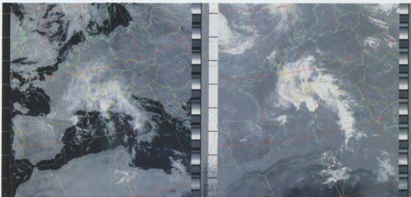
Fig.4 Come potete vedere dalla figura qui riprodotta, se i dati kepleriani non sono stati aggiornati o non avete messo a punto l'ora sul vostro computer, le mappe virtuali non collimeranno con l'immagine ricevuta. In questo caso, potete provare a migliorare l'immagine, scegliendo dal menu Image l'opzione Move Map Overlay.
