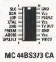
Fig.3 Connessioni viste da sopra e schema a blocchi interno dell'integrato in SMD siglato MC.44BS373CA.
