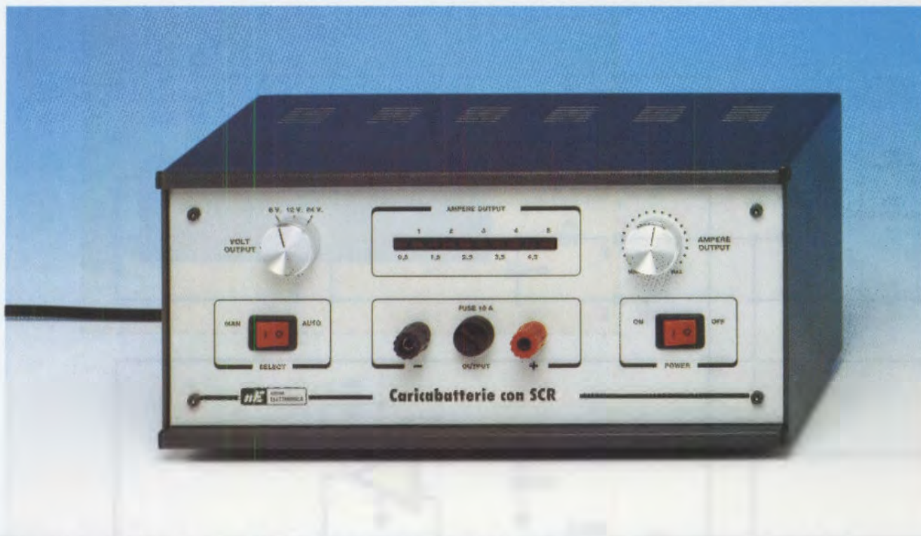
Fig.8 Foto del mobile metallico che racchiude il nostro caricabatterie professionale. A sinistra c'è il commutatore per scegliere la tensione di carica, mentre a destra trovate il potenziometro per selezionare la corrente, visualizzata in tempo reale sulla scala a diodi led. Al centro le boccole a cui collegare la batteria ed il fusibile di protezione della bassa tensione. In basso gli interruttori per l'accensione e per la selezione automatico o manuale.
