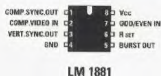
Fig.11 Connessioni dell'integrato LM.1881 visto da sopra. L'integrato stabilizzatore MC.78L05 e il transistor BC.547 sono invece visti da sotto. Ricordate che il terminale più lungo del diodo led corrisponde all'Anodo, e che il più corto corrisponde al Catodo.
