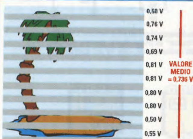
Fig.6 Se l'immagine è statica, e cioè priva di variazioni, anche i valori medi in tensione calcolati su ciascuna riga ed il loro valore medio complessivo sono costanti.
