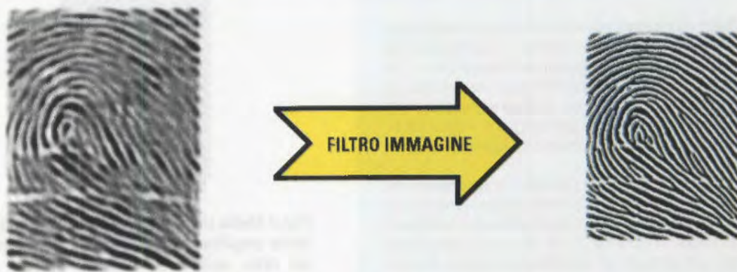
Fig.3 La prima acquisizione dell'impronta è una immagine composta da diverse tonalità di grigio. Successivamente viene effettuata via software una operazione di "filtraggio" che consente di ottenere una immagine in bianco e nero, esente da imperfezioni.
